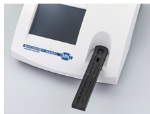
Fig. 18 : Vérifier l'alignement des encoches.
