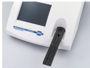
Abb. 18: Ausrichtung der Kerben prüfen
