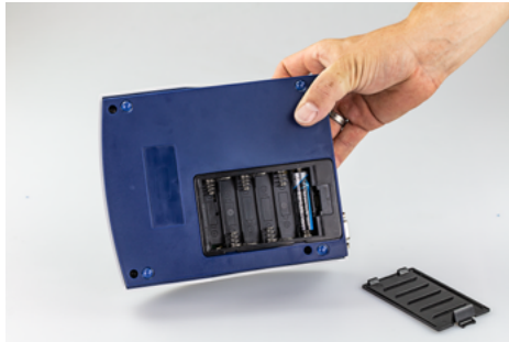
Pic. 15: Compartimento de pilas
