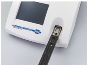
Abb. 17: Wiedereinsetzen des Teststreifenhalters
